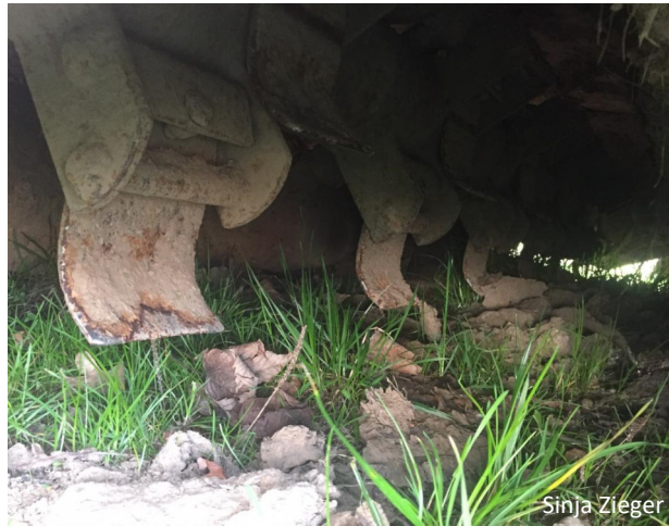
Schlegel an der Rotorwelle
